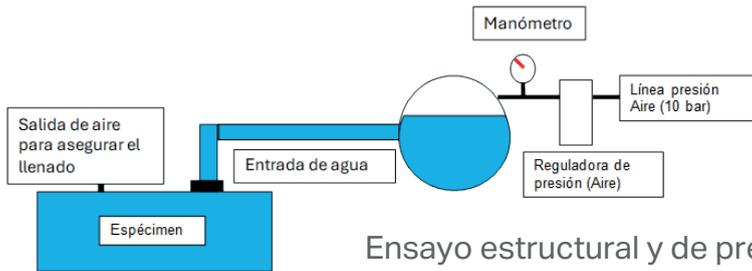
Ensayo estructural y de presión del espécimen.
